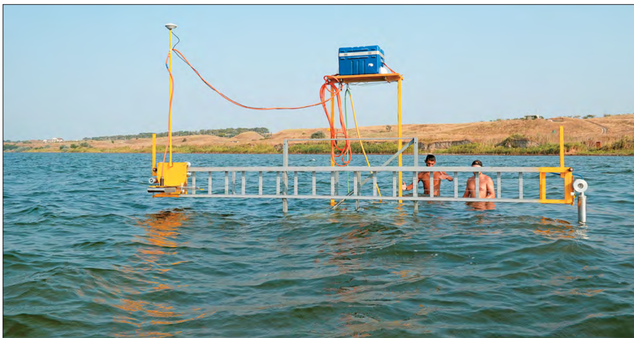
Зондирование структуры донных отложений профилографом Innomar SES-2000, установленным на телеуправляемой самоходной платформе.
