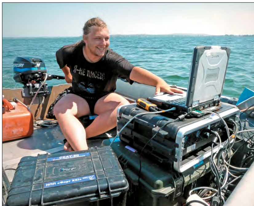
Зондирование структуры донных отложений профилографом SyQuest Bathy.
