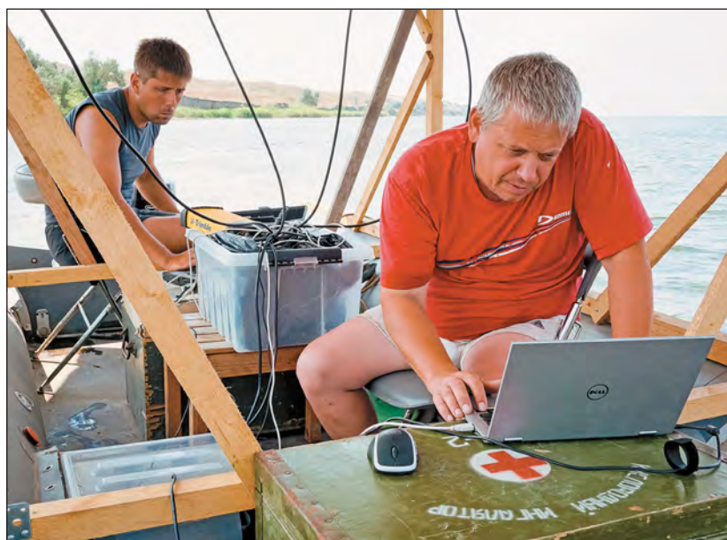
Профилирование донных отложений профилографом Trittech SeaKing.
